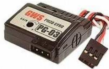
Слика 2.7. - Слика жироскопа
