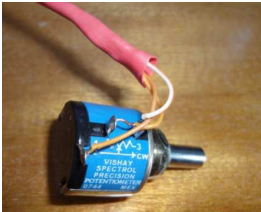
Слика 2.6. - Слика потенциометра - гониометра
