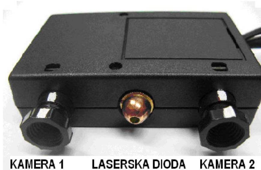
Slika 2.1 Izgled stereovizijskog sistema koji se sastoji od dve kamere, laserskog pokazivača i neophodne elektronike
